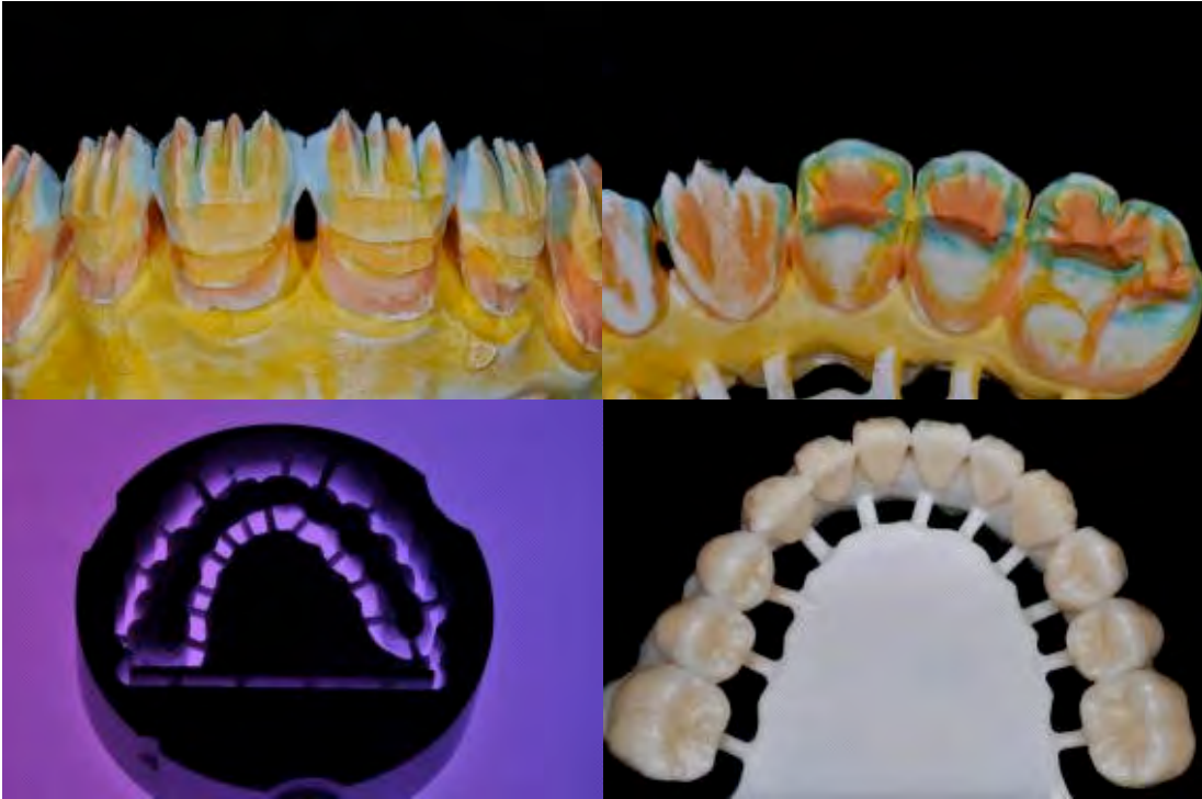
Figure: esempi di realizzazione di manufatti in zirconia monolitica con tecnica CAD-CAM
